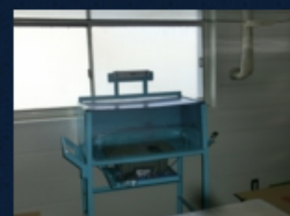
「同社が開発した歯科技工用粉末飛散防止ケース」
